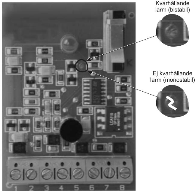
GS218N är en anpassningsenhet som används när man önskar ansluta glaskrossdetektorn GS200 till en centralapparat som saknar ingång för balanserad slinga.
