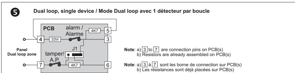
Note: a) [3] à [7] sont les borne de connection sur PCB(s)
